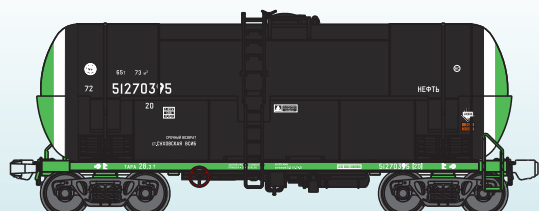
0013 Две цистерны для перевозки тяжелых нефтепродуктов с ванной обогрева РЖД 0013 Two tank cars for heavy oil with heating RZD (ep.VI)
